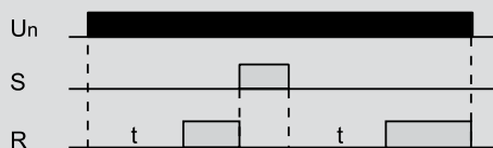
Диаграмма работы реле задержки включения ORT-A
